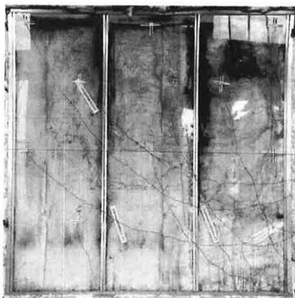
照片 2 耐火试验结束时试件情况
